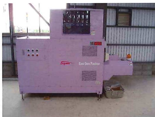
② 溶融減容機に投入 機内で破碎され、電気ヒーターにより熱せられて溶融して板状になって押し出されます。
